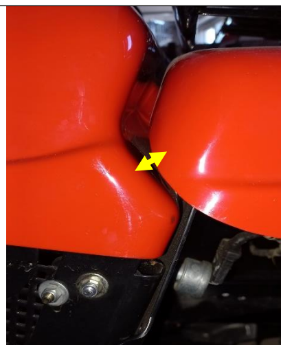
Vůle při pootevřeném a zatíženém koši
